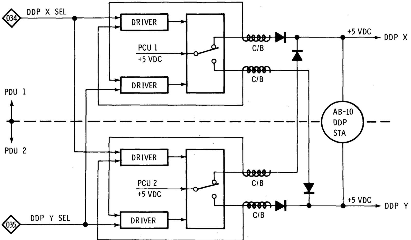
CIRCUIT BREAKERS (C/B) ISSUE SWITCHOVER SIGNAL AT  $270 \pm 27$  MA
