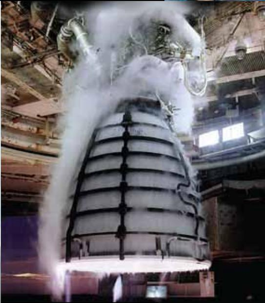
**SLS RS-25 ENGINE TEST**
